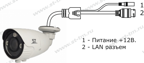
Рис. 1 Схема подключения видеокмеры
